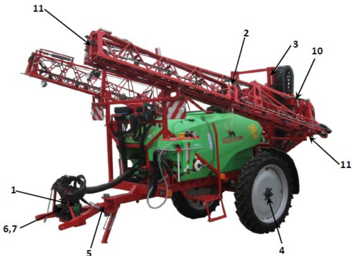
Rysunek 33. Punkty smarowania opryskiwacza APOLLO PHB.
