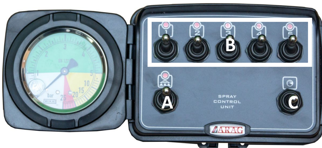
Rysunek 24. Panel sterowania układem cieczowym opryskiwacza.
